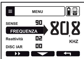
Spostare la frequenza per evitare venga disturbata da un rilevatore limitrofo o elettrovalvole disturbi.
