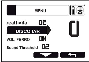
La discriminazione IAR è regolabile da 0 a 5. Può respingere ferrosi vicino alla superficie, pur accettando remota ferrosi. Aumentando il valore di discriminazione IAR a 5, si discriminerez lo stesso ferrosi distante. Le pepite d'oro sepolte in profondità su terreni mineralizzati generare una firma simile a ferroso. In questa ricerca si consiglia di impostare la discriminazione più basso possibile.
