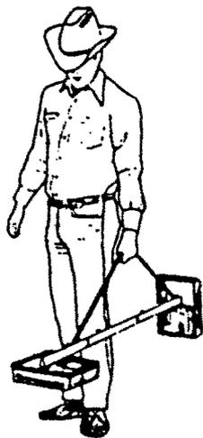
4. Mantenendo sempre l'apparato parallelo al terreno, ruotare lentamente in senso antiorario il controllo BALANCE (con la relativa freccetta) sino ad ottenere un azzeramento pronunciato tanto nel tono emesso che nell'indicazione data dallo strumento. A questo punto ruotando il controllo da 1/8 ad 1/4 di giro il tono dovrà essere completamente soppresso.
