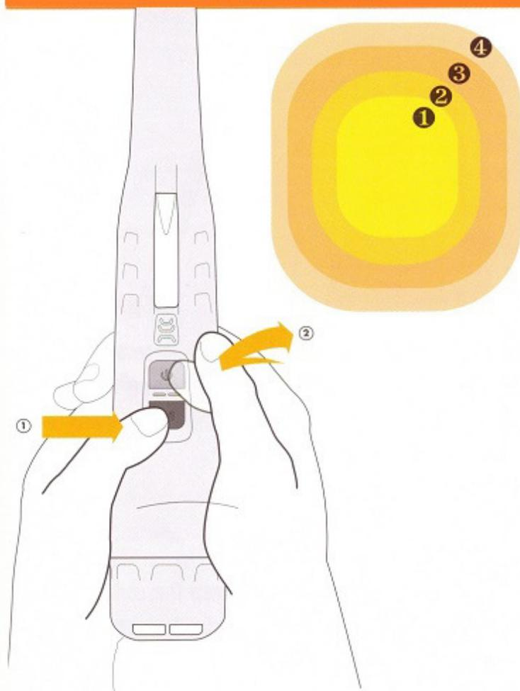
Quando è acceso, premendo il tasto MODE e premendo velocemente il tasto POWER si aumenterà la sensibilità da 1 a 4. Ogni livello emetterà un beep in più sino al livello 4 che emetterà un lungo beep.
