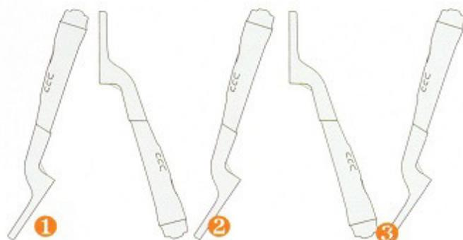
**Attivare Audio:** inclinare verso il basso tre volte per attivare la modalità di ricerca. Lo Scuba Tector è pronto per essere utilizzato. L'indicatore rosso resterà acceso per tre secondi. Lo Scuba Tector è pronto per essere usato.
