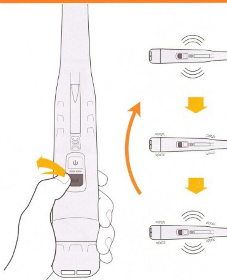
Quando è acceso, premendo il tasto MODE velocemente per cambiare il tipo di allarme, scegliendo tra Beep, Solo Vibrazione, Beep e Vibrazione.
