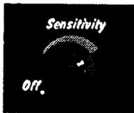
Questo pomello si trova nella parte sinistra del box comando. Permette l'accensione / spegnimento dello strumento e la regolazione della sensibilità. Questo controllo è spesso pensato solo in termini di profondità di rilevazione; esso permette anche una migliore compensazione delle influenze causate da campi elettrici e dalla mineralizzazione del terreno. In molti casi, questo
