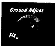
Questo controllo permette la bilanciatura del terreno per compensare la diversa mineralizzazione durante la ricerca. Ruotato completamente in senso antiorario si otterrà la posizione "fix", posizione che non richiede il bilanciamento manuale del terreno. Se in questa posizione la mineralizzazione del terreno è notevole, il Musketeer
