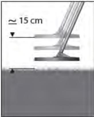
La modalità abbattimento avvia un processo semi-automatico che permette di regolare il bilanciamento del terreno in una porzione scelta come rappresentante del livello medio degli effetti del suolo. Da questo momento in poi, il valore del terreno misurato viene memorizzato e utilizzato come nuovo valore attivo di bilanciamento del terreno.
